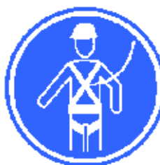
PROTECCIÓN INDIVIDUAL OBLIGATORIA CONTRA CAÍDAS
